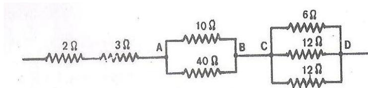
2. Calcular la resistencia total entre los puntos A y B del circuito de la figura
