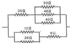
6. Hallar la resistencia total entre los puntos A y B de la figura adjunta.
